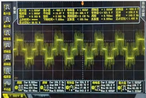
Изначальное пиковое напряжение: 2340 В Отфильтрованное пиковое напряжение: 1760 В
